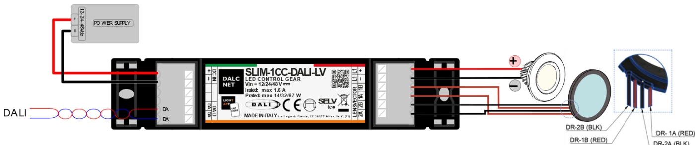
Figura 2: Schema di collegamento per il carico LED bianco o monocolori e la lente LensVector®
